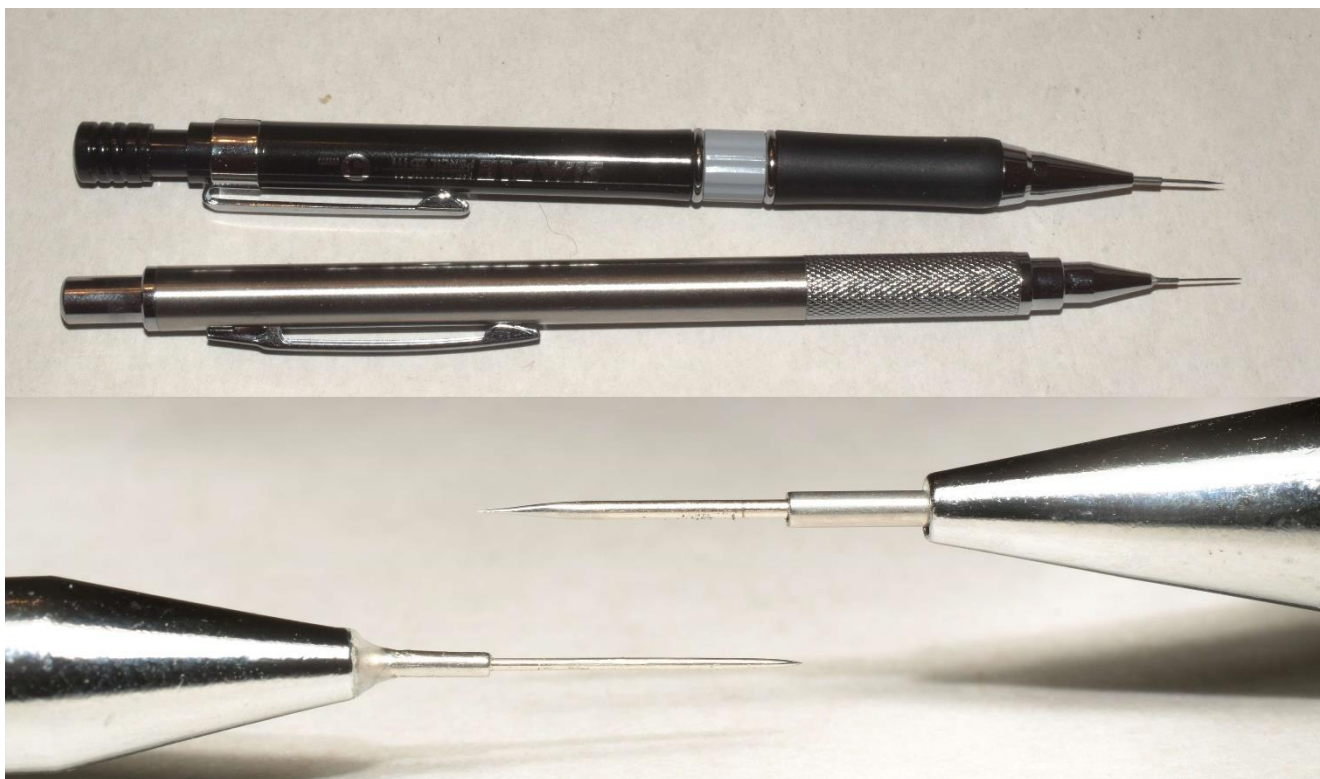
Рис. 3.3. Препарувальні голки, виготовлені з бісерних голок 0,3 мм і 0,5 мм та механічних олівців для графітових стрижнів 0,3 мм і 0,5 мм.
