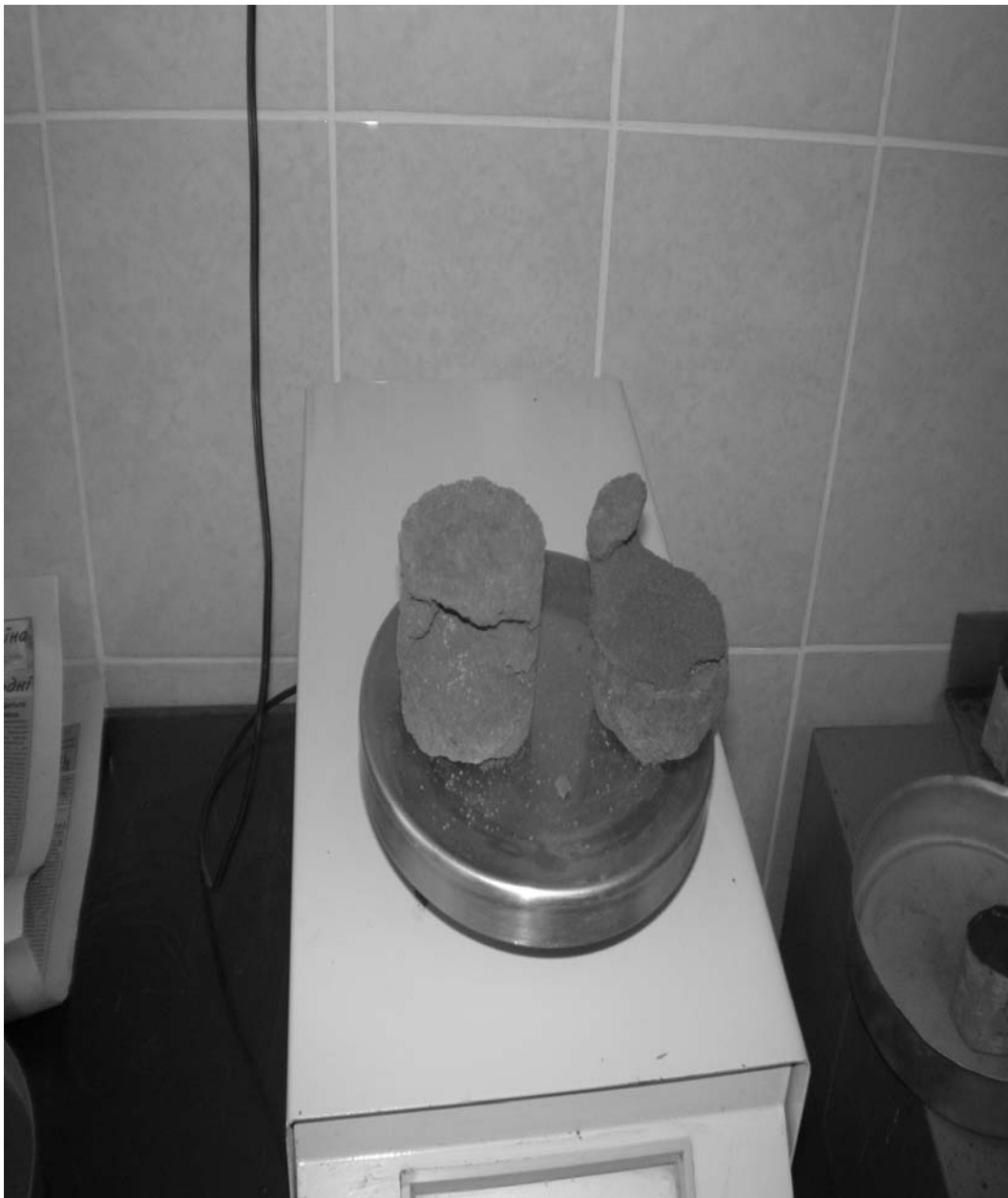
Рис. 2. Дослідний зразок ґрунту після дії повітряно-піщаного потоку.
