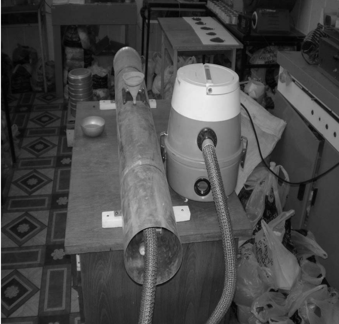
Рис. 1. Портативна лабораторна аеродинамічна установка.
